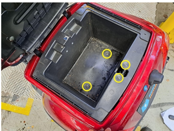
Irrota säilytyslokeron kiinnityspultit. (hylsy 8 mm).
